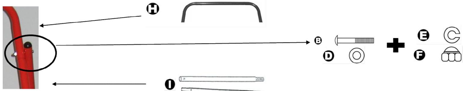
**latérale/Complete el montaje de la barra del lado/Assemblare la barra laterale**
