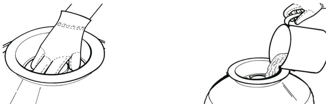
4. Enlevez l'entonnoir et nettoyez avec précaution l'ouverture du bac. Mettez la vanne multifonctions et le joint torique en place et fixez-les avec le collier de serrage. (Le raccordement de la pompe doit pointer dans la direction de la pompe.)
