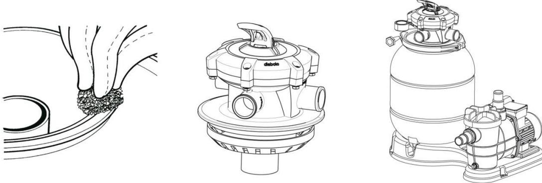
5. Raccordez le filtre avec la pompe avec l'aide d'un tuyau, des colliers de serrage et des raccords de tuyaux.
