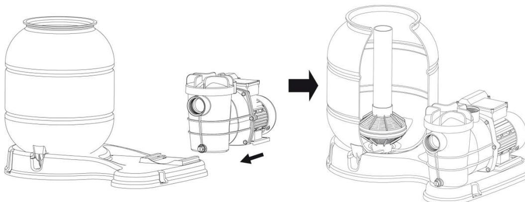
3. Placez le tube avec le diffuseur dans le bac, comme cela est indiqué dans l'image. Placez ensuite l'entonnoir dans l'ouverture du bac. Remplissez le bac avec du sable avec une quantité maximale de 19 kg.
