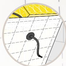
Pour assurer l'étanchéité au passage des gaines électriques sans fuites d'air
