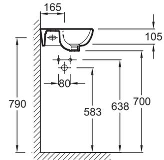
Description : Lave-mains d'angle. E4733. Collection : ODÉON UP. Dimensions : L 34 x P 34 cm. Poids : 7 kg. Matériau : Céramique. Installation : Autoportant. Percement robinetterie : Percé 1 trou de robinetterie. Solution d'angle pour un concept gain de place.
