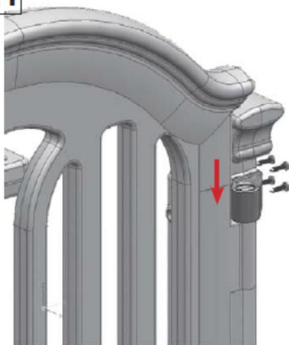
INSTALLEZ LE CADRE POSITIONNÉ, ET SÉCURISEZ AVEC LES 8 VIS
