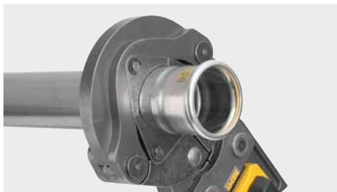
Boucles de sertissage (PR-3S) avec 3 segments pivotants montés sur une boucle articulée. Pour le sertissage de grandes dimensions. Sertissage optimal grâce à la fermeture des segments par entraînement radial de la boucle par une mâchoire mère.
