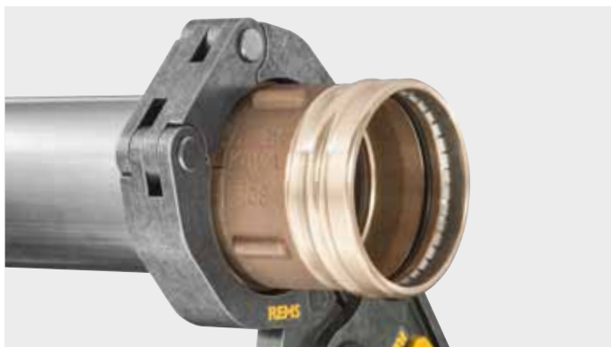
Boucle de sertissage REMS (PR-3B) avec 3 mâchoires pour le sertissage de grands diamètres. Sertissage optimal grâce à la fermeture des mâchoires par entraînement radial de la boucle par une mâchoire mère.
