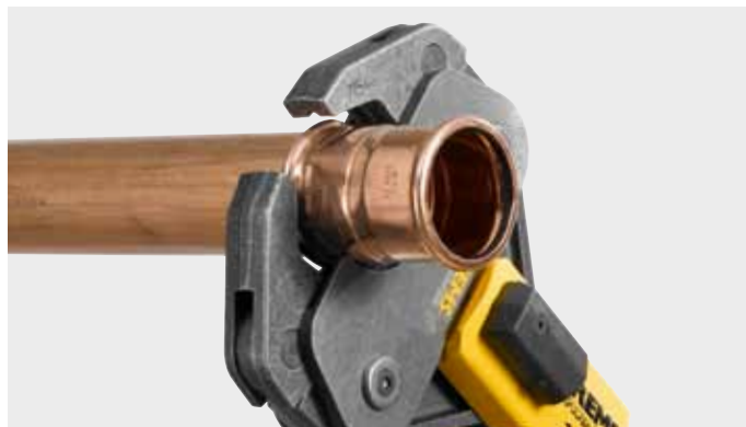
Pince à sertir REMS (4G) avec deux segments articulés, à l'avance parallèle. Pour un sertissage à pression rectiligne des moyennes dimensions.
