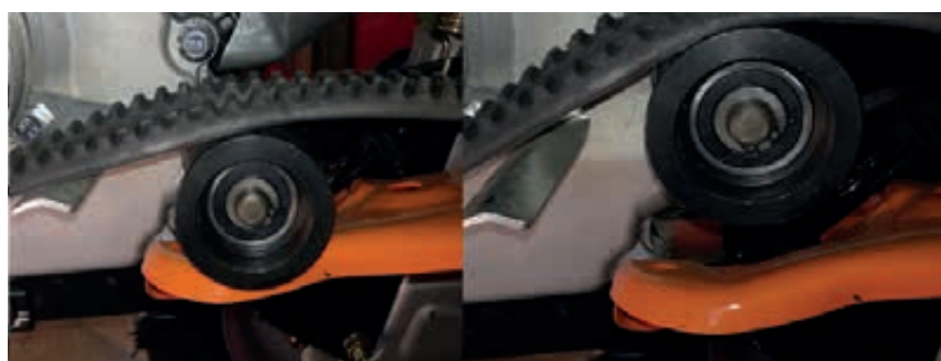
Position au repos (neutre) Position avec poignée enclenchée
