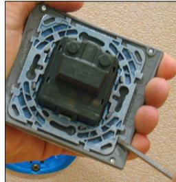
1. Démonter la plaque à l'aide d'un tournevis aux 4 coins du produit
