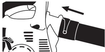
4. Gire siguiendo la ranura hasta que el anclaje llegue a su tope. Una vez terminado este procedimiento, se debe apretar el tornillo (A), para así fijar la unión del tubo de soplado.
