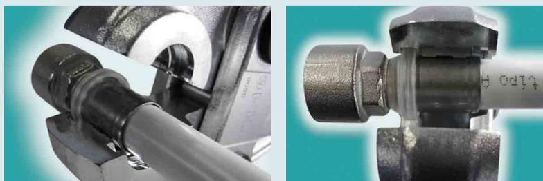
Raccord placé correctement avec mâchoire profil TH.
