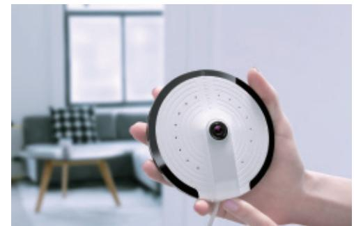
Premere e tenere premuto il pulsante di configurazione laterale per 5 secondi, quindi si udrà un segnale acustico che indica che il dispositivo UFO è passato alla modalità di configurazione WiFi.
