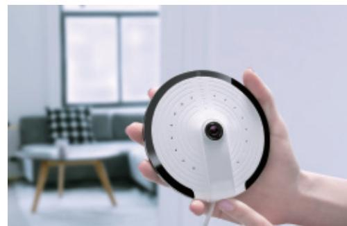
Prima sem soltar o Botão de Configuração de lado durante 5 segundos; ouvirá um aviso sonoro a indicar que a UFO mudou para o modo de configuração Wi-Fi.
