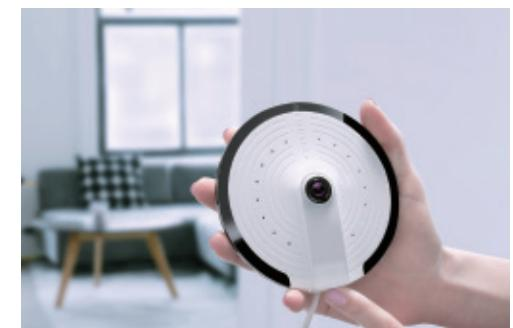
Houd de configuratietoets aan de zijkant gedurende 5 seconden ingedrukt, waarna er een toon klinkt die aangeeft dat de UFO naar de Wi-Fi-configuratiemodus is omgeschakeld.
