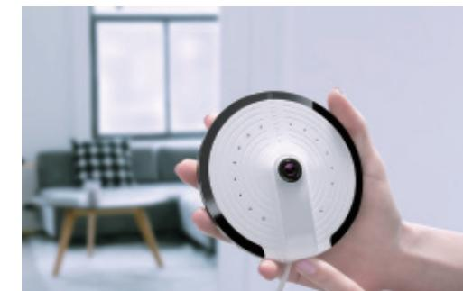
Appuyez et maintenez enfoncé le bouton de configuration sur le côté pendant 5 secondes. Vous entendrez un signal sonore qui vous indiquera que la caméra UFO est en mode de configuration Wi-Fi.
