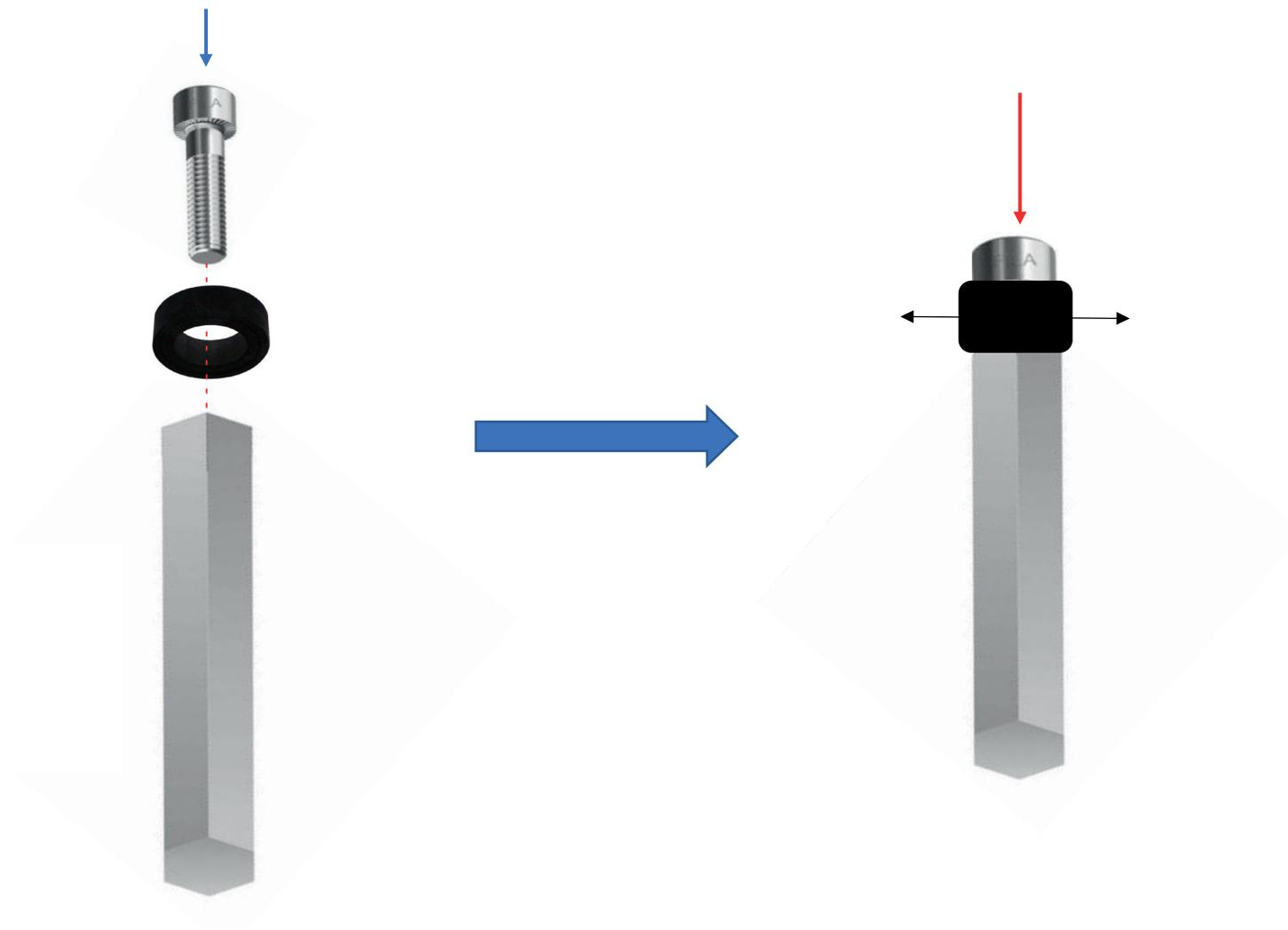
En serrant la vis de compression, le diamètre de l'anneau caoutchouc augmente lors de l'insertion de la manœuvre de secours dans le moteur, ce qui permet d'empêcher sa chute lors de l'utilisation. Une fois la fermeture du store effectuée, tirer sur la manœuvre de secours pour la libérer de son logement.
