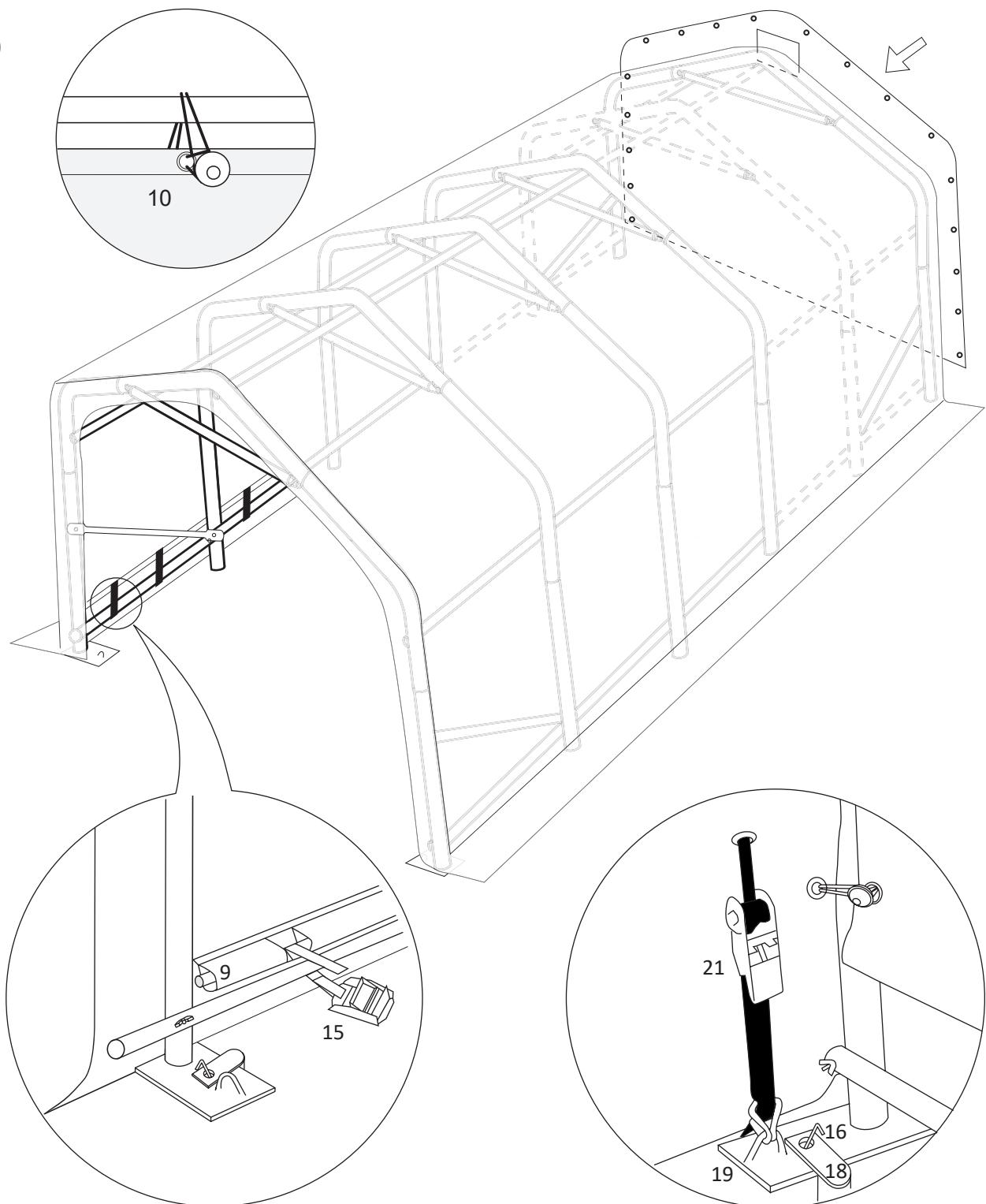
Führen Sie die Abspannstangen (9) in die Schlaufen am unteren Ende des Daches ein. Dann befestigen Sie diese mit den Gurtschlössern (15). Spannen Sie die Dachplane an den Zelteckfüßen (19) mit den Ratschenspannern (21) fest.
