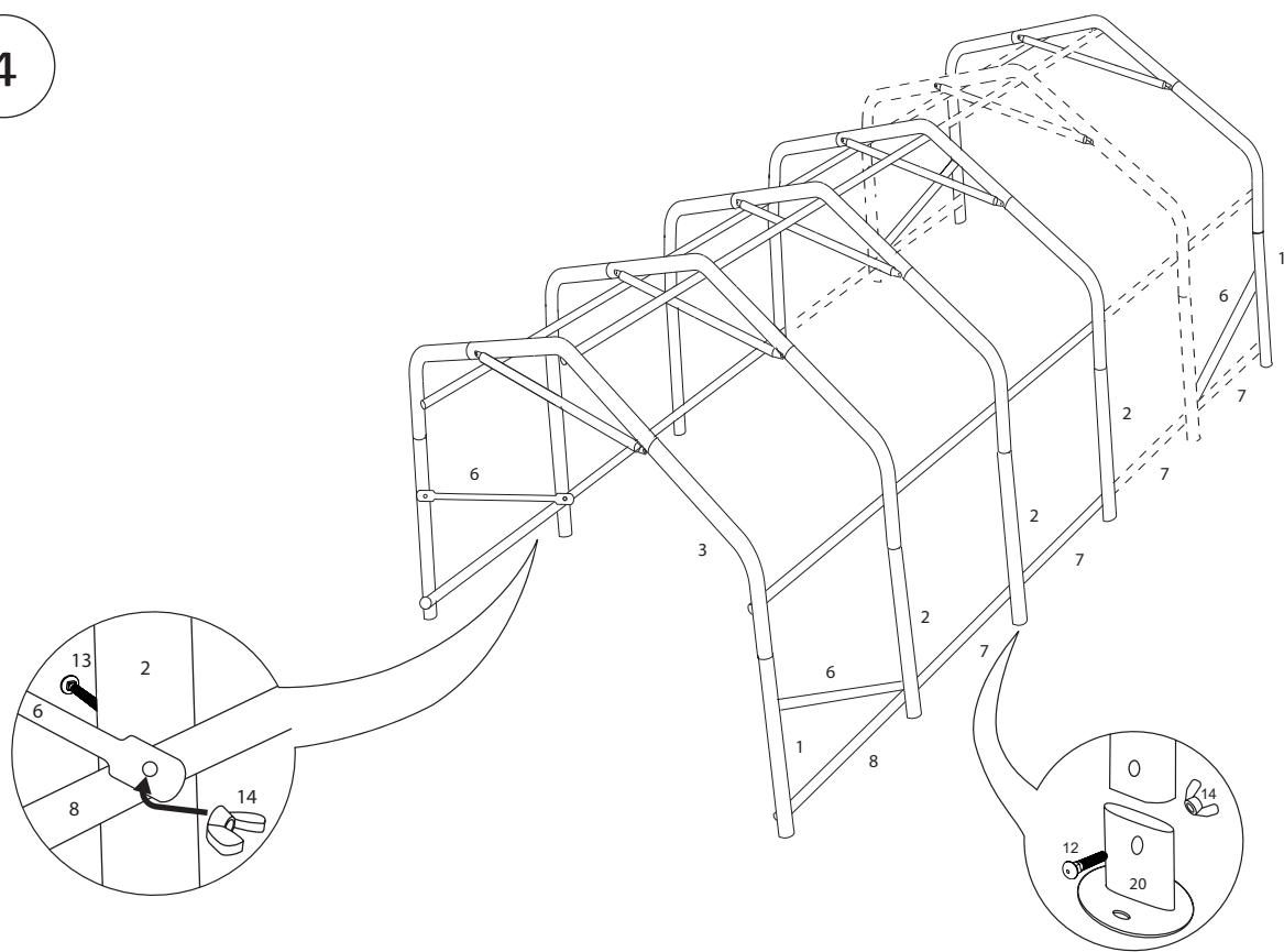
Beginnen Sie mit dem Aufstellen zunächst auf einer Seite. Verbinden Sie die Seitenbögen (3) mit den Beinen (1) und (2). Fixieren Sie das Gerüst durch die Diagonalstrebe (6). Befestigen Sie die Diagonalstreben (6) an den Beinen mit Hilfe der 75 mm Schraube (13) und der Flügelmutter (14). Mit den Bodenbügeln (17) und den Erdnägeln (11) befestigen Sie das Gerüst am Boden.
