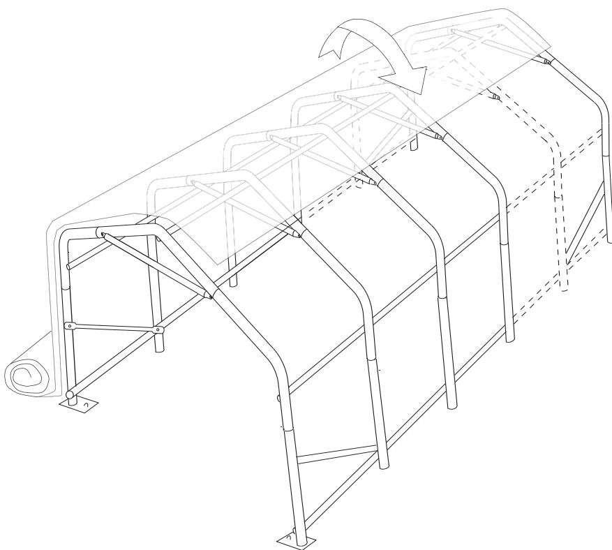
Entfalten Sie die Zeltplane und ziehen Sie diese über das Gerüst. Achten Sie besonders auf Kanten und Ecken, um Schäden bei diesem Vorgang zu vermeiden.
