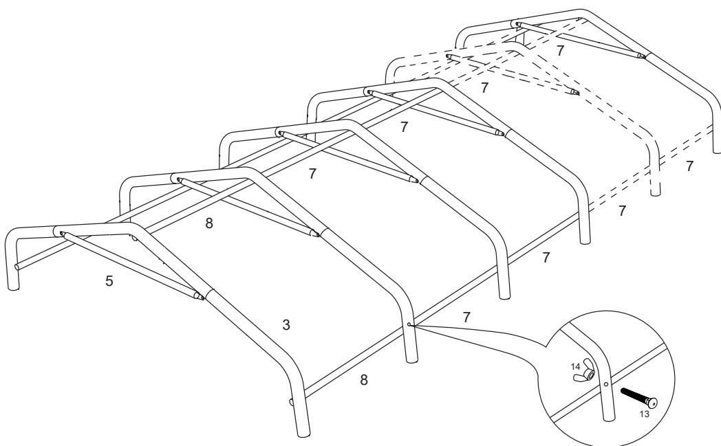
Nun werden die Bogenelemente durch die Seitenstreben 7 und 8 miteinander verbunden. Beachten Sie hierbei, dass im vorderen Segment nur die Streben 8 verwendet werden.
