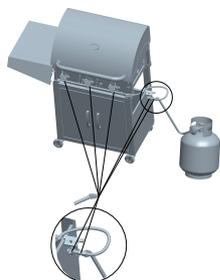
Fermeture de la bouteille de gaz (Fig. 2-A, 2-B)
