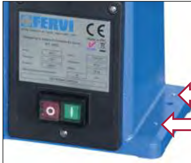
Figura 10 – Dettaglio fori di fissaggio.
