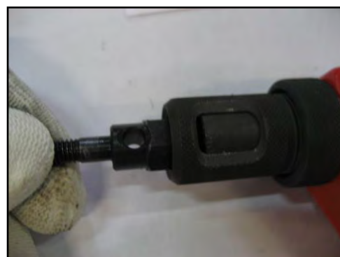
Figura 5 – Sostituzione dello stelo filettato
