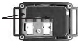
Fig. 6 Reset : Poner en contacto los dos ganchos de la pila
