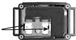
Fig. 6 Reset : relier les 2 supports de pile
