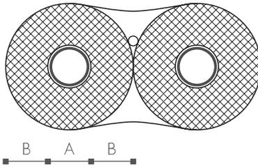
SOLAR-TUBE ECO ist ein doppeltes, vorgedämmtes Edelstahlwellrohr mit integriertem Sensorkabel für die Verbindung einer thermischen Solaranlage mit dem Heizkreislauf.
