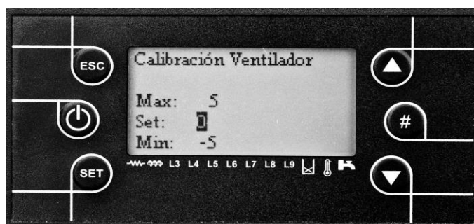
Menú Gestión de combustión (Calibración Ventilador)
