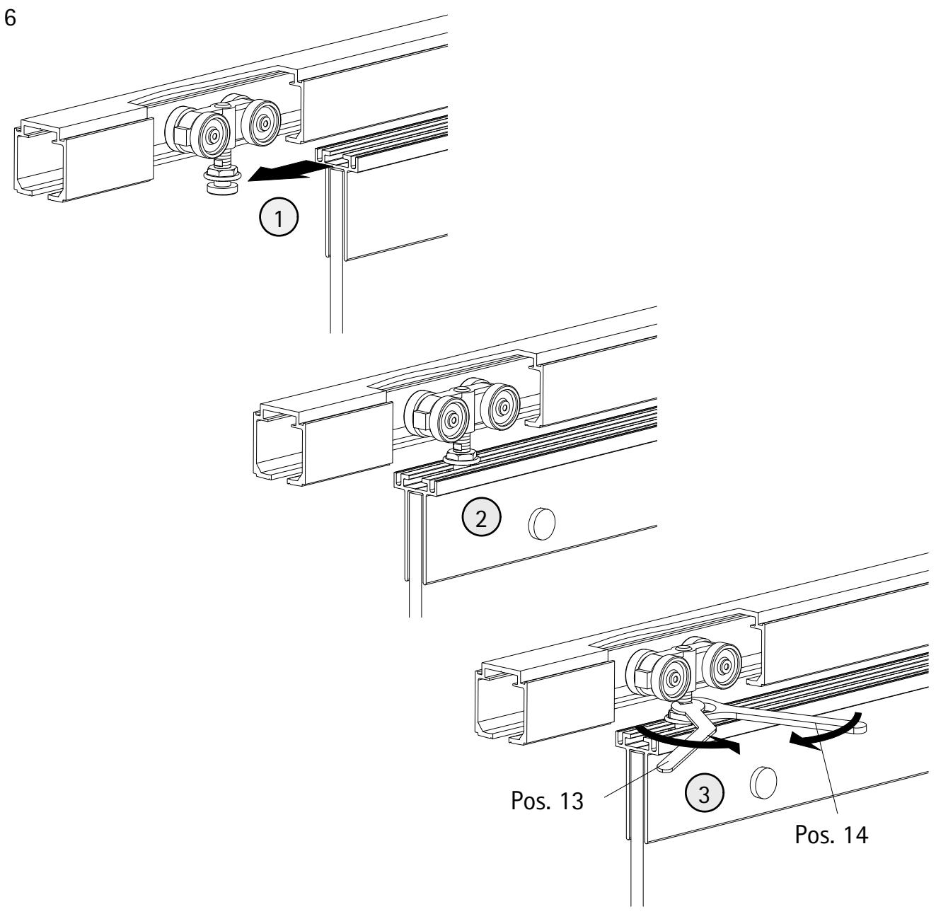
Schiebetür in die gewünschte geschlossene und geöffnete Position schieben und die Position der Bodenführung festlegen.
