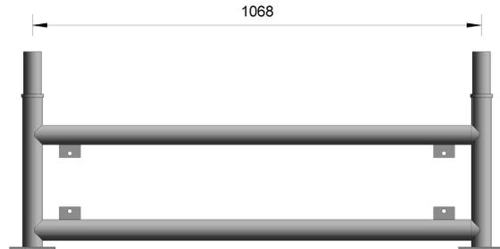
**9.2. TRAVERSO PER COLLEGAMENTO TELAIO DI BASE**
