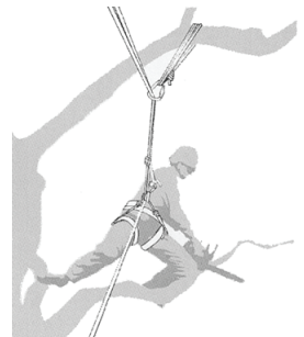
Figure B.3 — Ejemplo de redirección de la línea principal a través del punto de anclaje auxiliar
