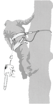
Figure B.2 — Ejemplo de fijación de la motosierra al punto medio central posterior en el arnés.
