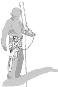
Figura B.1 — Ejemplo de fijación de la motosierra al arnés del usuario
