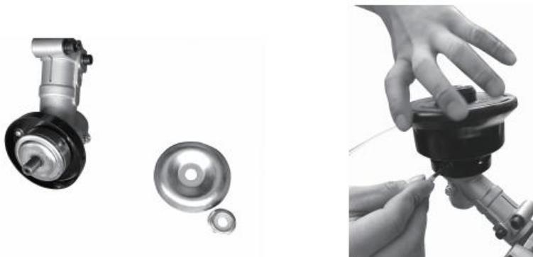
**3.3 Suelte la cabeza de corte de nylon.** Utilice un destornillador para sujetar la brida y luego gire la cabeza de corte de nylon en el sentido de las agujas del reloj hasta que esté bien fija, será reemplazada.
