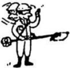
10. Compruebe que el accesorio de corte haya dejado de girar bajo el ralenti del motor antes de comenzar a utilizar la máquina.
