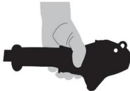
7. Cuando la máquina está al ralentí, la palanca del acelerador está como se muestra en la imagen. Para acelerar ha de pulsar primero la palanca de desbloqueo y luego apretar el botón del acelerador.
