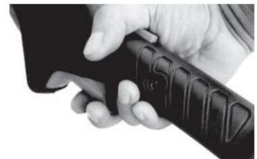
Tenga en cuenta que el interruptor de parada siempre se mantendrá en la posición de encendido si no lo presiona, por lo que si la máquina está caliente, puede volver a encender la máquina tirando del mango del arrancador directamente.
