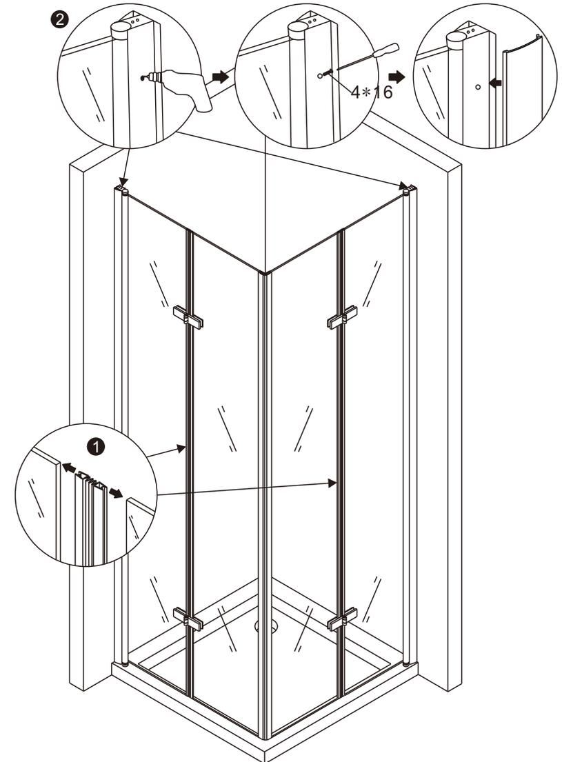
1. Verschrauben Sie die Glastüren mit den Scharnieren.
