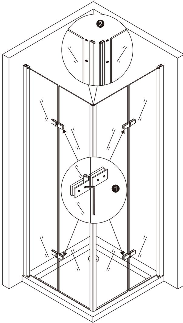
1. Richten Sie die Wandprofile (U-Profile) mit Hilfe einer Wasserwaage senkrecht an den Wänden aus. Idealerweise sollten die Wandprofile dabei gleichzeitig den Boden / die Wanne berühren, damit kein zu großer Spalt unten entsteht.
