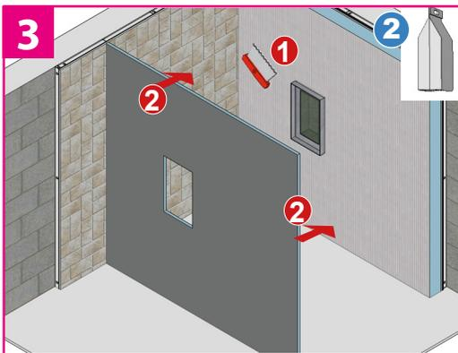
Replier la natte vers l'intérieur et compenser l'épaisseur de la platine périphérique de la niche tout autour avec un panneau à carrelé de 12,5 mm.
