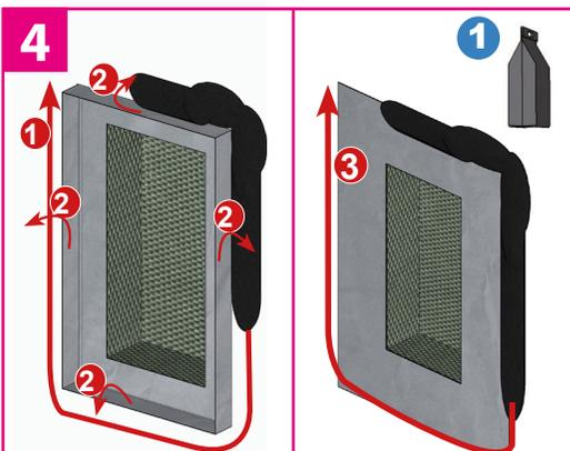
Appliquer du mortier colle sous l'emplacement de la natte. Puis maroufler la natte avec le mortier colle étanche pour étancher.
