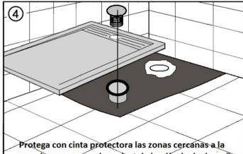
pared para no manchar e instale la válvula de desagüe>
