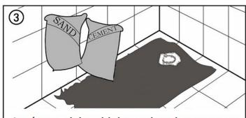
Asegúrese que la base del plato quede totalmente maciza y nivelada con terrazo sin pulir o mortero de segunda.
