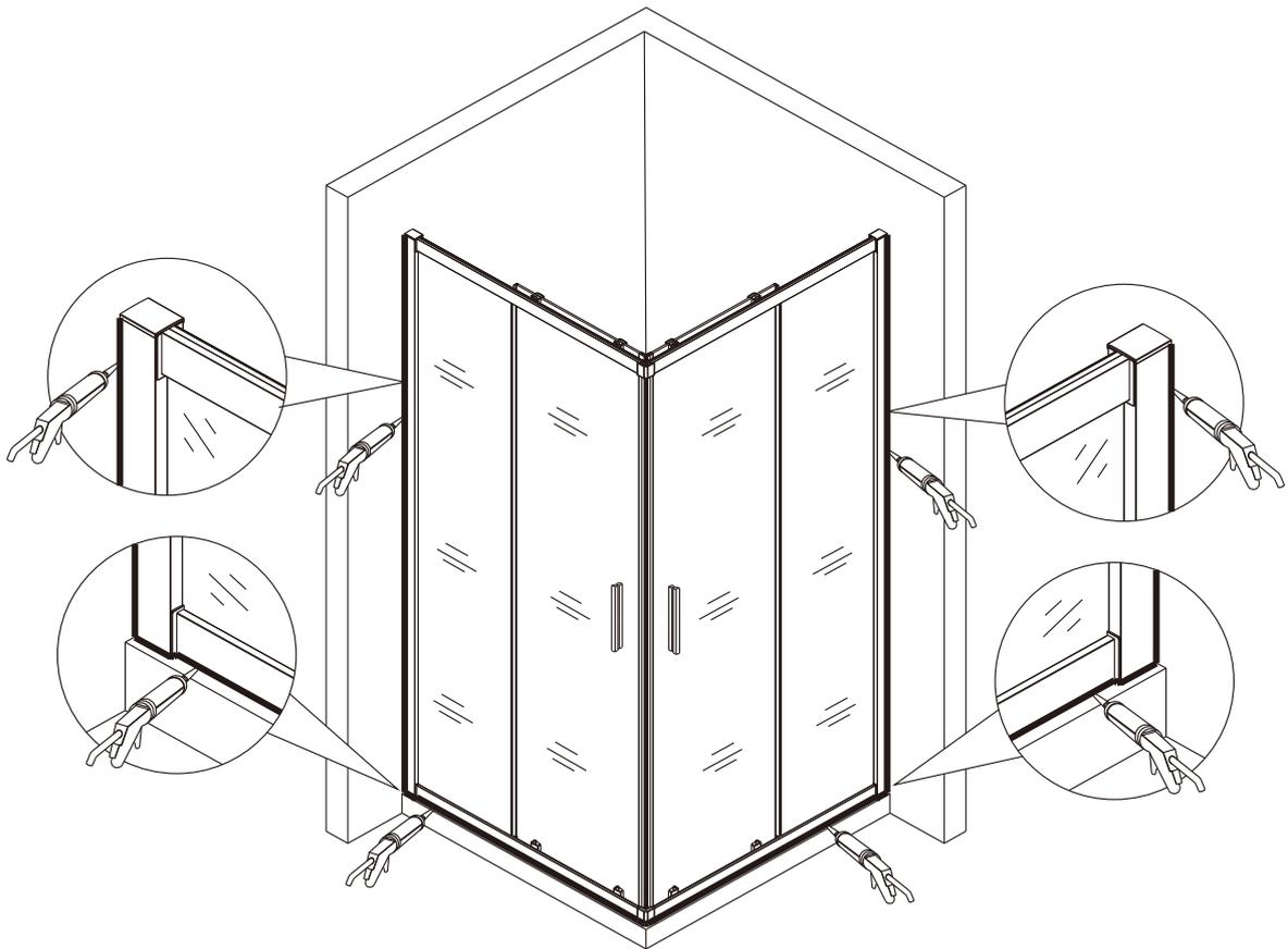
Aplicar silicón en el exterior del cuarto de ducha entre los perfiles y la pared; y entre el marco y el plato de ducha, para mejorar la impermeabilidad. Esperar 24hr después de aplicar silicón para usar.
