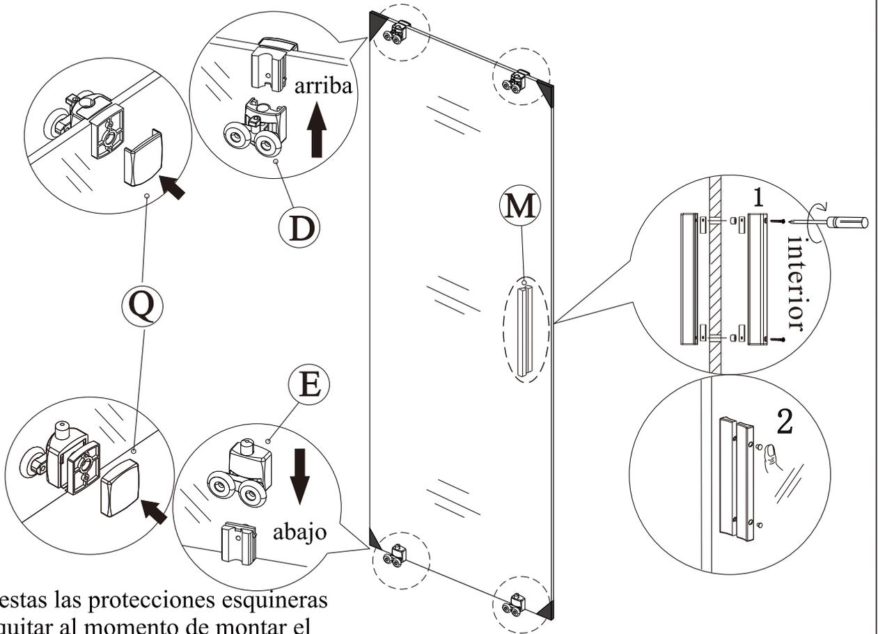
Matener puestas las protecciones esquinas del cristal, quitar al momento de montar el cristal e instalar los otros accesorios.
