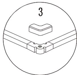
Achtung bitte die senkrechten festen Alu-Profil von innen mit Silikon abdichten und die waagerechten Schienen von innen mit Silikon abdichten. Bitte niemals von außen Seiten mit Silikon abdichten, da sich das Duschwasser in den Profilen hochstauen kann und somit die Abtrennung undicht wird.
