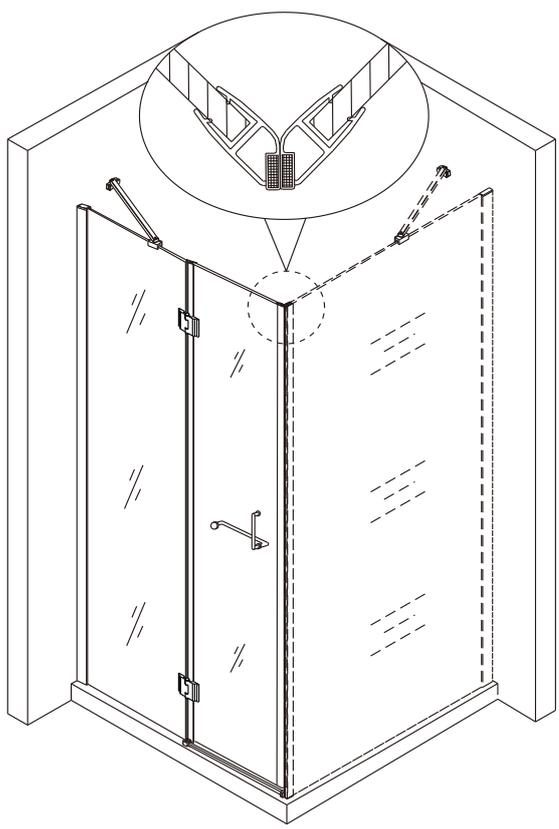
Achtung bitte die senkrechten festen Alu-Profil von innen mit Silikon abdichten und die waagerechten Schienen von innen mit Silikon abdichten. Bitte niemals von außen Seiten mit Silikon abdichten, da sich das Duschwasser in den Profilen hochstauen kann und somit die Abtrennung undicht wird.
