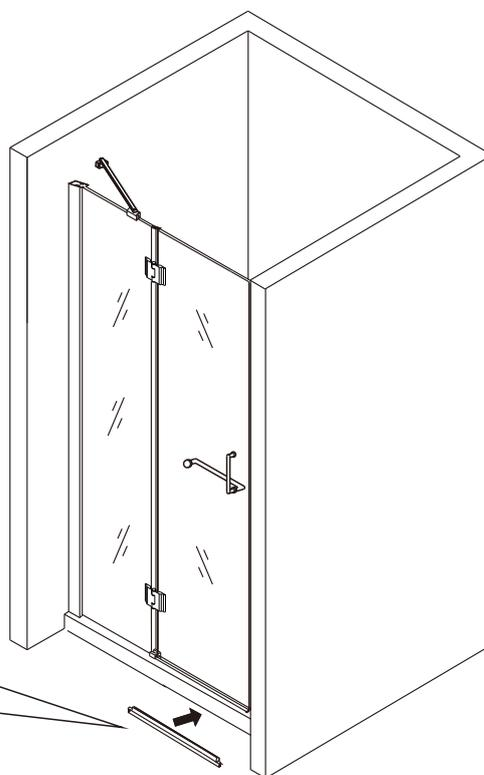
Achtung bitte die senkrechten festen Alu-Profil von innen mit Silikon abdichten und die waagerechten Schienen von innen mit Silikon abdichten. Bitte niemals von außen Seiten mit Silikon abdichten, da sich das Duschwasser in den Profilen hochstauen kann und somit die Abtrennung undicht wird.
