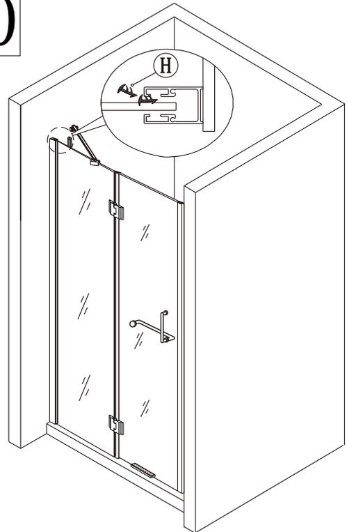
**Bevor Sie irgendeine Bohrung vornehmen, bitte unbedingt die Abtrennung lose an die Wand halten und ausrichten. Danach selbstständig die Bohrlocher mit einem Filzstift oder Ähnliches makieren. Bitte grundsätzlich vor der festen Montage, die Abtrennung lose zum Ausrichten an die Wand halten.**
