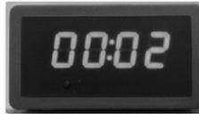
in diesem Modus wird die Zeit in Minuten nach dem letzten Start des Generators angezeigt
