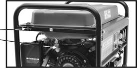
1. Die Position der Starterklappe beim Start mit Benzin.
