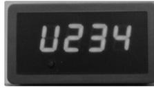
in diesem Modus wird der Spannungspegel des Generators in Volt angezeigt
