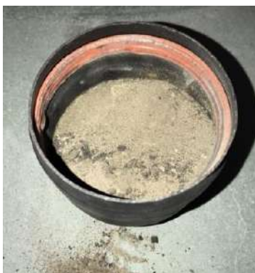
Beispiel eines verschmutzten Deckels
