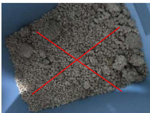
Agglomerazione di pellet di scarsa qualità
