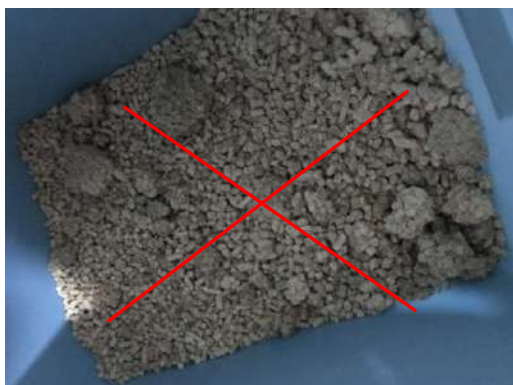
Agglomération de granulés de mauvaise qualité
