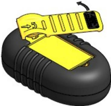
Retirez le couvercle du compartiment à piles et remplacez la pile. Des piles alcaline Duracell sont recommandées.
