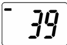
Le compte à rebours commence à 50. Lorsque le compte à rebours arrive à 00, l'instrument affichera la concentration de CO à l'aide de trois chiffres. Un indicateur de niveau de batterie s'affiche dans le coin supérieur gauche de l'écran et dans le coin inférieur droit de l'écran apparaîtra l'unité de la mesure en «ppm».
