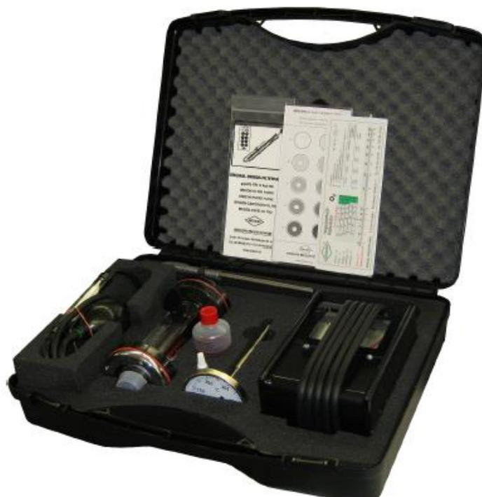
Der BRIGON Öl-Service-Messkoffer ist eine über Jahrzehnte 100.000fach bewährte Zusammenstellung praktischer Messgeräte. Mit dem Bi-Metall-Thermometer ermitteln Sie die Abgastemperatur. Der nach dem Orsat-Prinzip arbeitende CO<sub>2</sub>-Indicator dient zur Messung des Kohlendioxid-Gehaltes in Volumenprozent. Aus Temperaturwert und CO<sub>2</sub>-Gehalt lassen sich mit Hilfe des mitgelieferten Rechenschiebers der feuerungstechnische Wirkungsgrad und der Abgasverlust der Anlage berechnen.
