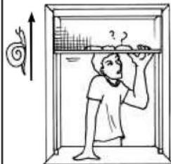
**FR** | La toile ne remonte plus : Le ressort nécessite d'être retenu. Pour cela dévissez l'embout du coffre côté ressort (côté non gradué) en le maintenant afin de ne pas vous blesser. Tournez l'embout avec son ressort de plusieurs tours et revissez le tout.
