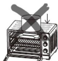
No coloque ningún objeto entre la base del horno y la superficie sobre la que esté colocado. Cualquier objeto que se encuentre debajo del horno puede quemarse. No coloque ningún objeto sobre el horno cuando esté en marcha porque el calor podría deformarlo, fisurarlo o dañarlo.
