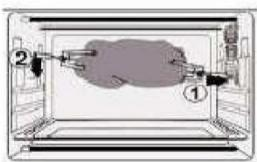
Insérez les fourches du tournebroche dans l'orifice du tournebroche, puis installez le plateau sous le tournebroche
