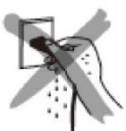
No moje el cable de alimentación ni manipule el aparato con las manos mojadas. Desenchufe siempre el cable tras el uso del aparato o cuando este esté sin vigilancia. Si lo deja enchufado, un mal funcionamiento puede provocar un incendio.
