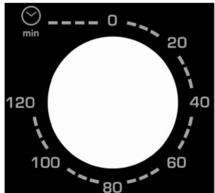
Réglez le minuteur sur la durée de cuisson (en minutes) appropriée pour le plat que vous allez cuisiner en le tournant dans le sens des aiguilles d'une montre.
