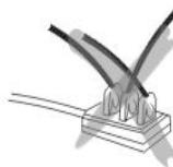
El horno tiene que estar conectado a una toma eléctrica adaptada. Introduzca la clavija por completo en el enchufe. De lo contrario podría calentar en exceso. No utilice una toma de luz corriente. No conecte nunca varias clavijas en una misma toma.
