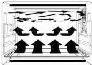
Gracias al ventilador situado en el lado de la cavidad, el aire caliente circula por la totalidad del horno, el calor se reparte mejor y la cocción es más uniforme.
