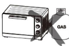
Cuando el aparato esté en uso no lo coloque nunca cerca de un quemador de gas, una fuente de calor fuerte o un ventilador eléctrico, etc., ya que podría dañar el control de la temperatura.
