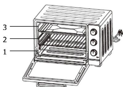
U kan de hoogte van de schotel afstellen op 3 verschillende niveaus in functie van de bereidingen. Bijvoorbeeld, als u een gratin klaarmaakt en als u wil dat het bovenste deel harder gebakken is, gebruikt u de derde richel. Om een kip te braden, gebruikt u de eerste of de tweede richel.
