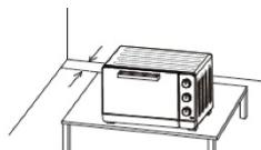
Als de oven zich te dicht bij een muur bevindt, kan dit brand of vlekken veroorzaken. Zorg ervoor dat de gordijnen, enz. niet in contact komen met de oven.
