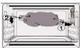
Breng de vorken van het draaispit in in de opening van het draaispit, plaats vervolgens de braadslede onder het draaispit
