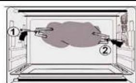
Inserte las horquillas del asador de espada con el asa del asador de espada, y seguidamente retire la bandeja recolectora
