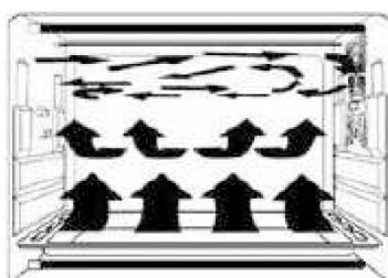
Dankzij de ventilator aan de zijkant van de holte, circuleert de warme lucht in de volledige de oven, hitte wordt dus beter verdeeld en het bakken verloopt zo eenvormiger.
