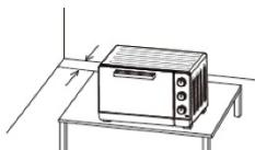
Si el horno se coloca demasiado cerca de una pared existe riesgo de que esta se queme o ensucie. Vigile que las cortinas, etc. no entren en contacto con el horno.
