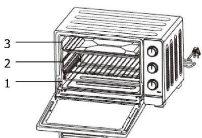
Puede regular la altura de la bandeja en 3 niveles diferentes en función de los platos que desee cocinar. Por ejemplo, si prepara un gratén y desea que la parte superior quede más tostada, utilice el tercer soporte. Para asar un pollo utilice el primero o el segundo.
