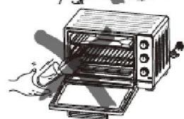
يجب الإمساك دائماً بمقبس الكهرباء عند فصل الجهاز عن التيار الكهربائي. لا يجب أبداً شد سلك الكهرباء، فقد يتسبب ذلك في انقطاع الأسلام الداخلية للفرن.
