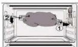
Inserte las horquillas del asador de espada en el orificio del asador de espada, y seguidamente instale la bandeja recolectora debajo del asador de espada
