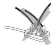
De oven moet op een aangepast stopcontact aangesloten worden. Stop de stekker volledig in het stopcontact. Zo niet zou de oven overdreven warm kunnen worden. Gebruik geen stopcontact voor verlichting. Sluit nooit verschillende stekkers aan op eenzelfde stopcontact.
