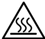
**- Attention surface chaude. La surface peut être chaude et ne doit pas être touchée sans précaution.**
