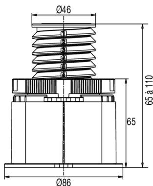
Descriptif CCTP : Kit de réhausse 5 pieds. E62133. Collection : Hors collection. DIMENSIONS : 8,60 x 8,60 x 11 cm. POIDS : 1 kg. MATÉRIAU : N/A. TYPED'INSTALLATION : Posé. DESCRIPTION KIT DE RÉHAUSSE : 5 pieds réglables de 6,5 à 11 cm pour rehausse de receveurs. ANTIDÉRAPANT : Non.
