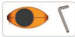
Visser les vis avec les écrous à l'aide de l'outil fourni. Serrer jusqu'à faire plaquer les colliers l'un contre l'autre. Les colliers se déforment légèrement pour compenser l'espace visible avant le serrage. A l'instant où les colliers sont plaqués, effectuer encore un tour de serrage.
