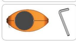
Schrauben und Muttern mit dem mitgelieferten Werkzeug verschrauben. Die Schrauben dabei so fest anziehen, dass die Schellenhälften fest zusammengepresst werden. Die Schellenhälften verbiegen sich beim Festziehen leicht, wodurch sich die zuvor sichtbare Lücke schließt. Sind die Schellenhälften fest zusammengedrückt, die Schrauben noch eine Drehung weiter drehen.
