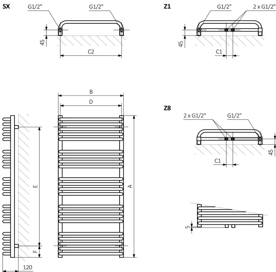
A – hauteur B – largeur C1-C5 – écartement des raccordements D – écartement des consoles en horizontal E – écartement des consoles en vertical F – distance de l'axe de la console inférieure au bord inférieur du collecteur
