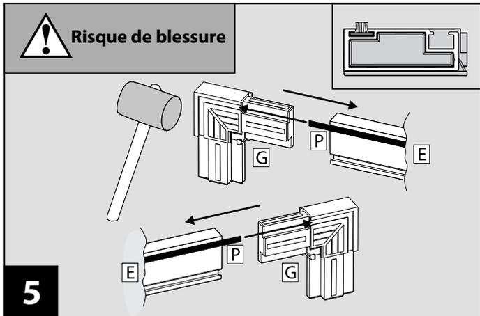
Fixer le connecteur d'angle gauche/droit **G** en haut à gauche du profil haut **E**. Poussez le joint à brosse **P** dans les connecteurs d'angle.
