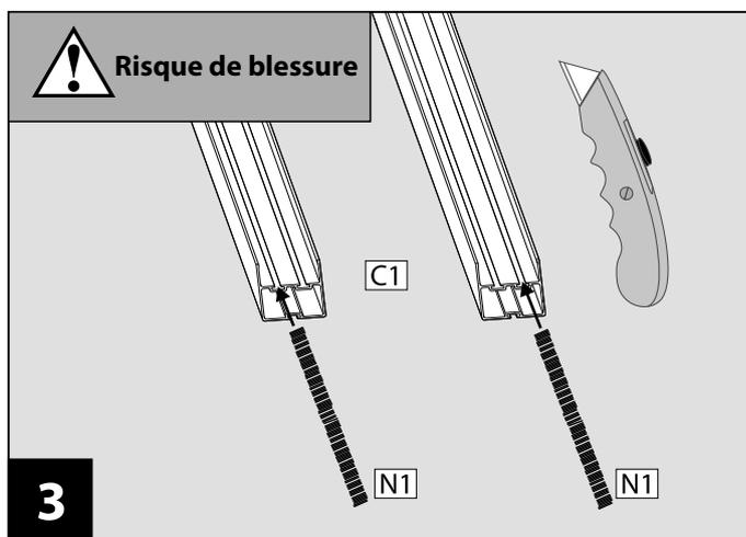
Insérer le joint brosse **N1** dans les profils latéraux **C1** et les recouper à la même longueur.
