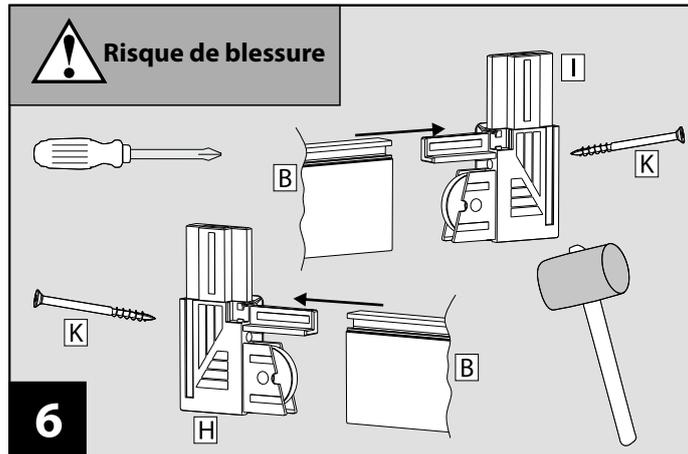
Fixer le connecteur d'angle bas à roulette gauche **H** et droit **I** au profil de protection contre les chocs **B**.
