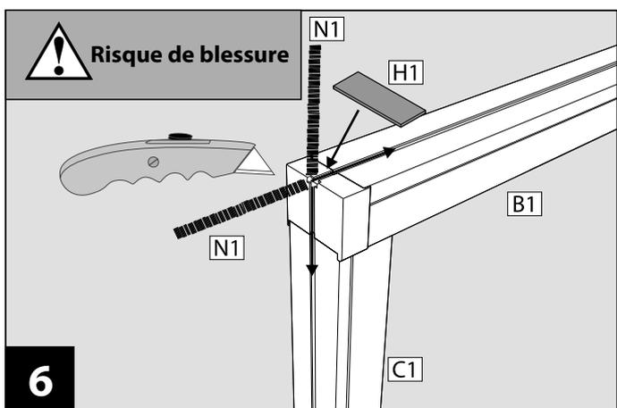
Glisser le joint brosse **N1** dans le profil de guidage haut **B1** et les profils latéraux **C1** et le recouper à la bonne longueur. Ôter le film de protection d'un côté des patins antidérapants **H1** et les coller en haut sur les raccords d'angle gauche **F1** et droit **G1**.
