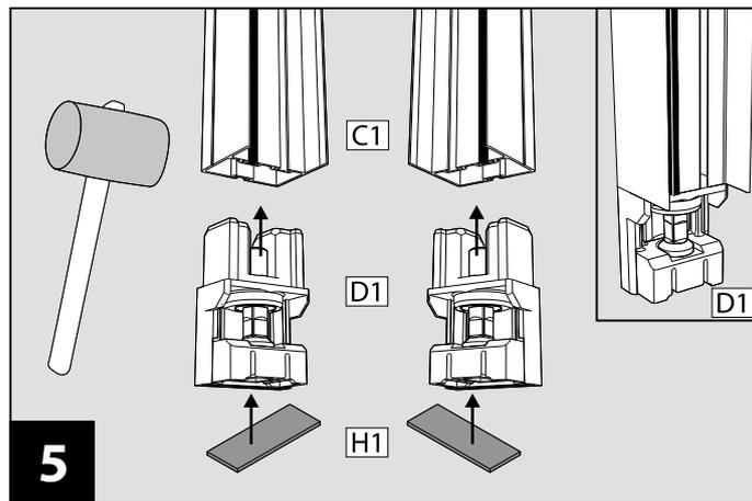
Insérer les pieds de serrage **D1** dans les profils latéraux **C1**.
