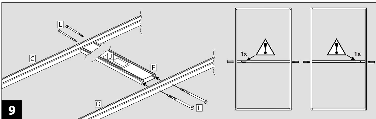
Insérer le profil central **F** entre les profils **C** et **D** à hauteur des trous de vis et les assembler avec les vis à tête bombée **L**.
