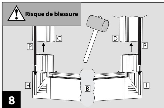
Fixer les profils **C** et **D** avec les connecteurs d'angle bas à roulette gauche **H** et droit **I**.
