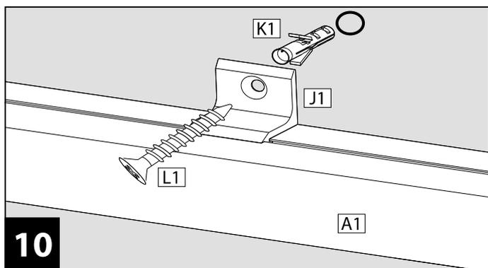
Insérer les chevilles **K1**, selon le type de support, un autre type de cheville peut être nécessaire (non fourni).
