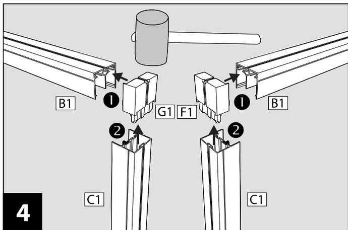
Relier le profil de guidage haut **B1** et les profils latéraux **C1** avec les raccords d'angle gauche **F1** et droit **G1**.
