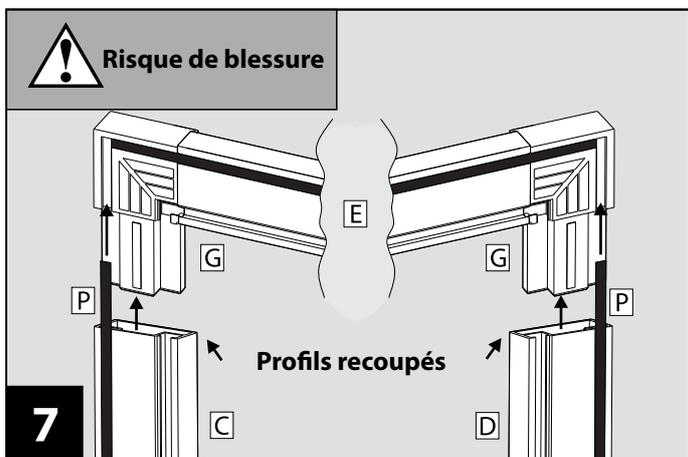
Fixer le profil haut **E** et les connecteurs d'angle gauche/droit **G** avec les profils **C** et **D**.
