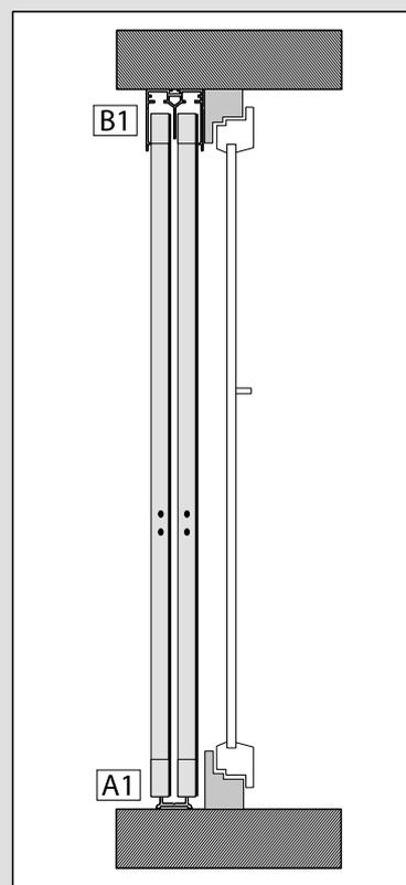
Glisser les portes coulissantes entièrement assemblées en diagonale de bas en haut dans le profilé de guidage **B1** du cadre, puis placez-les directement vers le bas sur le rail de roulement du cadre **A1**.
