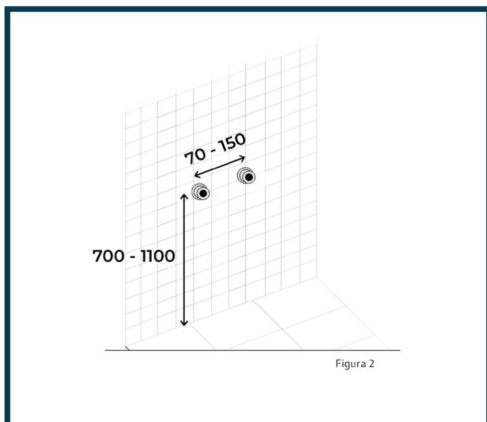
Per il posizionamento dei collegamenti dell'acqua si consiglia di distanziare gli allacci dell'acqua calda e dell'acqua fredda da un minimo di 7 cm a un massimo di 15 cm. Per quanto riguarda l'altezza degli allacci si consiglia di distaccarsi dal pavimento da un minimo di 70 cm a un massimo di 110 cm.
