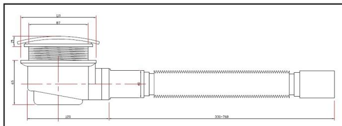
Il piatto doccia è dotato di piletta di scarico sifonata ispezionabile, diametro 90 mm, ingombro sottoquota 65 mm.
