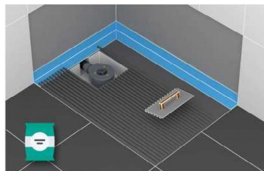
Colocar perimetralmente cinta impermeabilizante en los ángulos que forma las paredes con el plato y aplicar cemento cola con una llana ó talocha dentada de 1 cm.
