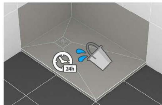
Comprobar que el plato queda bien instalado y que desagua correctamente antes de proceder al alicatado del resto del baño y al montaje de la mampara u otros elementos. (Esperar 24h para alicatar)
