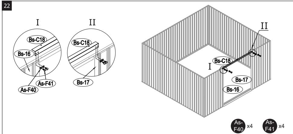
**!** **NOTE:** Reprenez les mesures des diagonales de l'abri et faites les corrections éventuelles pour que la construction soit d'équerre. Ainsi les panneaux de toit s'ajusteront mieux et les trous correspondront. N'ancrez pas le cadre de plancher à cette étape. Il est plus facile d'installer les panneaux de toit en montant sur un escabeau. Placez toujours une rondelle sous les têtes de vis et de boulons utilisés pour le toit
