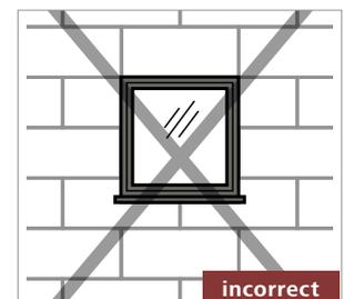
Lors de la pose des panneaux *STEICOprotect* dans les angles des ouvertures, il ne faut pas mettre de joints horizontaux ou verticaux au droit du tableau.
