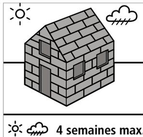
Dans le cas d'une exposition prolongée de la façade, un surfacage est à prévoir avec un ponçage des désaffleurs et comblement des éventuels joints. Les évacuations d'eau pluviale doivent être éloignées de la façade pour éviter les projections.
