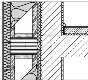
Si, suite à des mouvements importants de la structure, un joint apparaît entre deux panneaux à la jonction entre deux étages, il faut le combler avec une pièce de bois résistante à la compression. Cette pièce devra faire la même épaisseur que celle du joint et avoir une profondeur équivalente à l'épaisseur de l'isolant moins 20 mm. Le trou restant devra être rebouché avec STEICO*multi fill* sur les 20 mm d'épaisseur restants.
