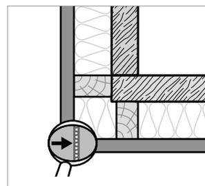
Le mastic STEICO*multi fill* est posé sous forme de cordons d'environ 8 mm de diamètre sur les panneaux déjà montés.
