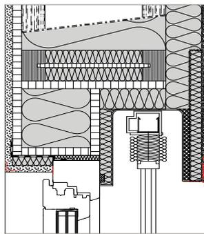
La surcôte d'isolant (épaisseur min. 40 mm) sera collée au coffre de volet et à l'ITE avec du STEICO*multi fill*.
