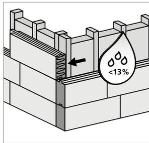
L'humidité du matériau peut être mesurée avec un humidimètre pour bois Gann BL H41. Si l'on ne dispose pas d'un tel outil, on peut coller hermétiquement un film de polyéthylène d'environ 70 cm sur 70 cm sur les panneaux STEICO*protect*. Si au bout de 24 h il y a condensation de vapeur d'eau, les panneaux ne peuvent pas être enduits.
