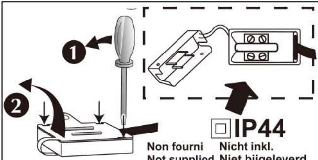
Cet appareil doit être raccordé à l'alimentation par l'intermédiaire d'une boîte de raccordement Classe 2, IP44 conformément à la norme NFC 15-100 et UTE C 15-801.
