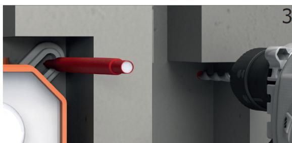
3 Marquer les points de fixation. Retirer le boîtier, puis percer votre mur avec les mèches adaptées à celui-ci.
