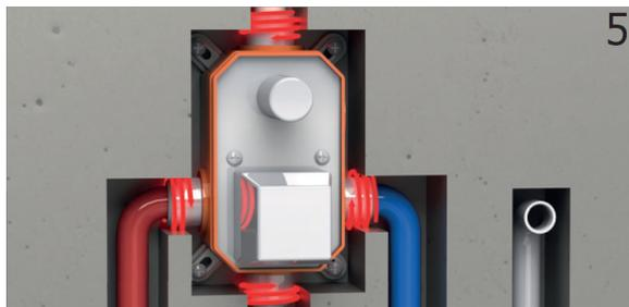
5 Installer et raccorder les tuyaux d'arrivée et de sortie au boîtier d'encastrement.
