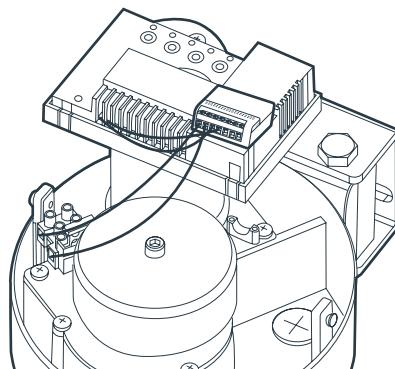
Connecter les fils de sortie du contact sec comme sur le schéma ci-dessous. Le module peut être alimenté soit par une tension secteur de 230V AC ou alors par une tension DC 24V qui peut venir d'un kit solaire, bien respecter la polarité +/-.
