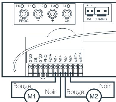
Le moteur qui s'ouvre en premier doit être connecté à la sortie M1 de la carte électronique.
