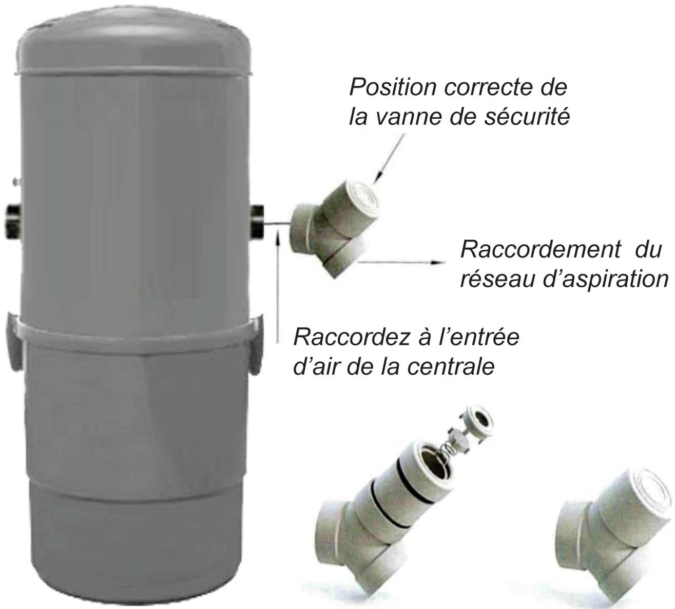
*La mise en place de cette valve évite la casse du moteur si il fonctionne à vide : Moteur en marche avec toutes les prises d'aspiration fermées. Recommandé pour toutes les installations avec la mise en route par système sans fil.*
