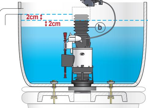
**FR VÉRIFICATION DU TROP-PLEIN :** s'assurer que le haut du trop-plein (b) est à minimum 2 cm au dessus du niveau d'eau et en dessous de l'ouverture pour raccordement du robinet.
