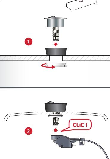
**FR FIXATION DU BOUTON : Cas n°1 :** le diamètre du trou de couvercle du réservoir compris entre 14 et 38 mm. La bague se place au dessus du couvercle.
