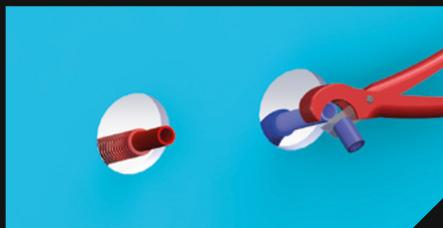
**2 Sortir les tubes PER vers l'avant de la cloison, et ajuster la longueur à l'aide d'un coupe tube.**
